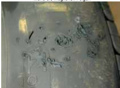
Reifenreinigung mit Hochdruck... ...und die möglichen Folgen
